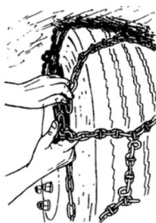
После этого руками расправьте цепь по поверхности колеса путем стягивания внешней боковой цепи, после чего зацепите замок боковой цепи.
