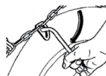
Подтяните замок, установив натяжной ключ в звено на цепи и повернув его на 90 градусов таким образом, чтобы замок цепи установился в натянутое положение (6).
